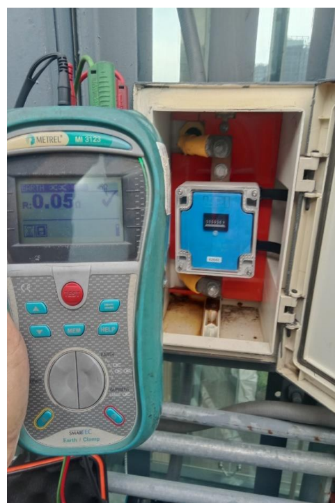
ภาพที่ 17-18-19-20 : ภาพแสดงการตรวจสอบอุปกรณ์นับจำนวนไฟฟ้าและวัดค่าความต้านทาน
