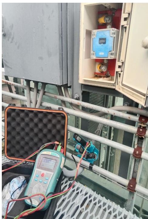
ภาพที่ 17-18-19-20 : ภาพแสดงการตรวจสอบอุปกรณ์นับจำนวนไฟฟ้าและวัดค่าความต้านทาน
